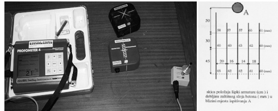
Uređaj za utvrđivanje položaja, rasporeda i sastava šipki armature u betonu
